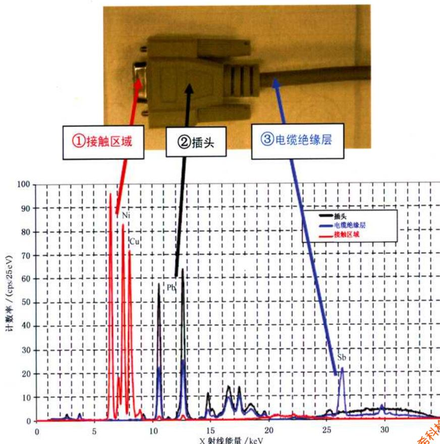
图 C.2 RS232 电缆及其 X 荧光射线谱
