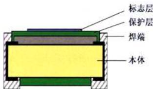
图 B.4 无引脚矩形片状元件示意图
