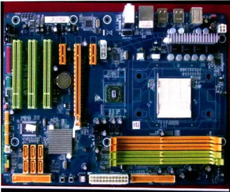
图 B.1 典型电路板组件(PCBA)图
